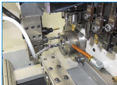
NC自動旋盤内部
