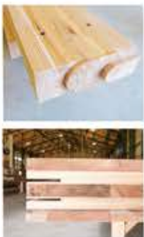
↑木造建築物の木工事部分の加工を工場ですす「プレカット」。3棟の加工棟で加工し、建築現場へタイムリーに届けてます。
