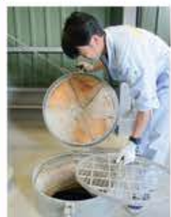
サイロの上部に登ってマンホールから内部に結露ができていないかを目視で確認するのも大切な仕事です。
