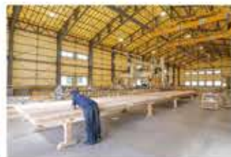
↑木造建築物の木工事部分の加工を工場ですす「プレカット」。3棟の加工棟で加工し、建築現場へタイムリーに届けてます。
