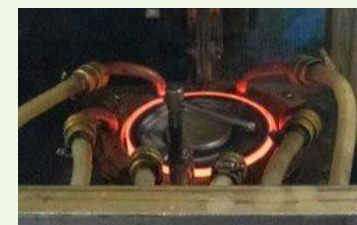
▲高周波の電磁誘導で部品の表面を加熱し、強度を上げる『高周波焼入装置』
