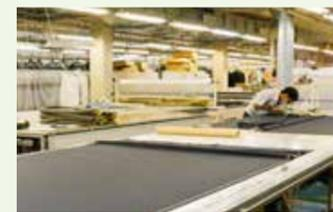
▲大型スチーム機で反物の生地をしわをなくした後、自動裁断機で裁断します
