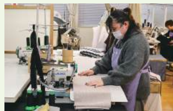
▲ロックミシンを使用した工程。生地裁断後のほつれを防止し、品質を保ちます
