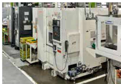
▲小型精密部品の内・外径を高速かつ高精度に加工する機械。自動で高い生産性を発揮します
