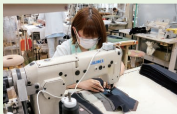
▲襟加工はパーツの形状に沿った曲線を縫い合わせる高度な技術が要求されます
