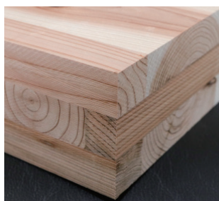
CLT パネルの構造。積層することで火災や耐震性にも優れる。
