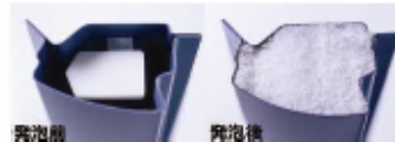
発泡前 発泡後 自動車ピラーに使用されている防音材 (自動車焼付け工程の熱を利用し発泡)
