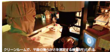
クリーンルームで、平面の滑らかさを測定する検査が行われる
