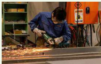
▲わずかな凹凸も建て付けに影響するため、削りやパテ処理で滑らかに仕上げます
