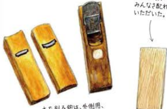
木を削る鉋は、外側用、 内側用と使い分ける。
