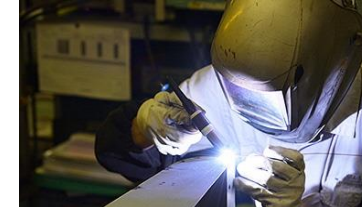
▲ 大仙工場の板金溶接作業
