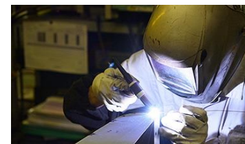
▲ 大仙工場の板金溶接作業
