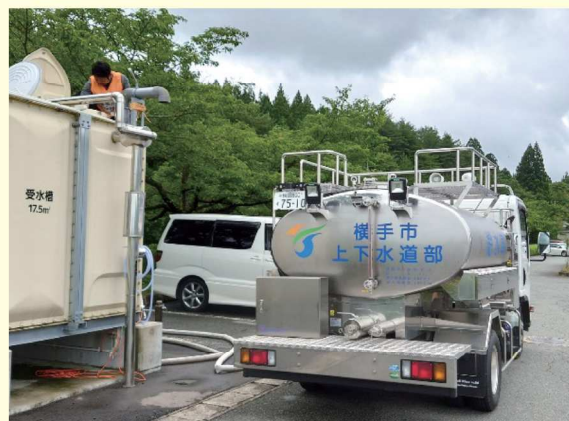
▲加圧式給水車による給水訓練時の様子
