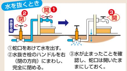
※水抜き栓（ハンドル式）は「半開」「半閉」の状態だと地下に水が漏れてしまいます。必ず「全開」または「全閉」の状態で使用してください。
