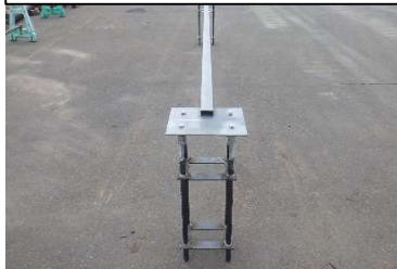
支柱を等間隔に設置するため作製した治具を活用した作業状況
