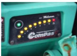
転圧完了センサー付き転圧機械
