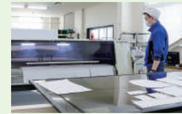
▲レーザー裁断機は複雑な形状の裁断が可能で、ほつれにくいのが特徴です
